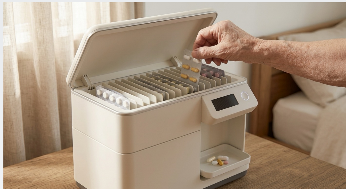
顶盖掀开 · 板竖着、窄边朝下落进两片隔板之间
