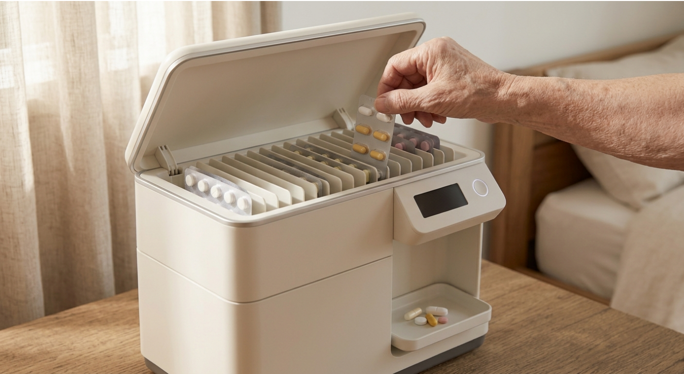
图 3.1-3 顶面装填。掀盖 → 20 个槽口一次露出 → 板竖着、窄边朝下落进两片隔板之间，板面与隔板同向。从上往下看只看得见一排细边。概念渲染，非制造图。
