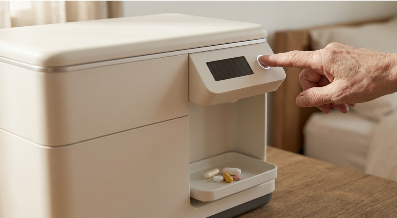
图 3.1-2 交互面。 屏默认熄灭（深色哑光条），按钮背光环在到点时亮起；屏、按钮、落药口在同一条竖线上——看到、按下、伸手接。碟里是一次给药事件的几粒药，不是一粒。 概念渲染，非制造图。
